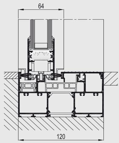
Slimpatio 68 est un coulisant à haute isolation et dormant caché. Une combinaison idéale du confort et de l'élégance. Le design minimaliste du coulisant Slimpatio 68 permet à un maximum de lumière naturelle d'entrer et offre une vue panoramique sur les environs. Slimpatio 68 a été développé et testé pour répondre aux exigences strictes au niveau de l'isolation thermique et de l'étanchéité à l'eau et au vent.
